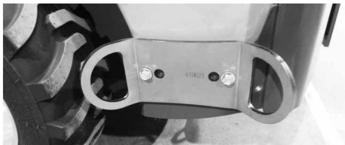
Suporte de conexão A418623 instalado na lateral da estrutura traseira. São necessários dois suportes para instalação lateral.
