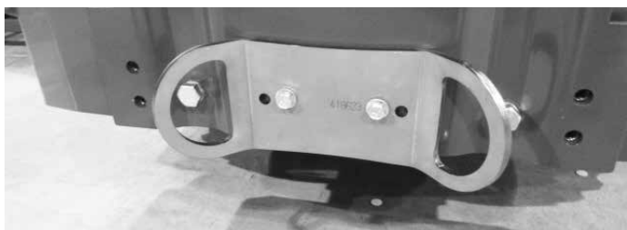
Suporte de conexão A418623 instalado no para-choques traseiro ou no contrapeso
